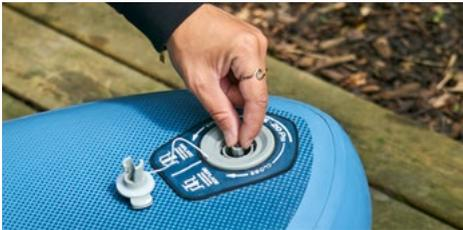
3 Assurez vous que le bouton de la valve soit en position haute pour la phase de gonflage. Il suffit d'appuyer sur le bouton et de le tourner vers la droite ou la gauche. Si vous ne respectez pas cette recommandation, la planche se dégonflera au retrait de l'embout de gonflage.
