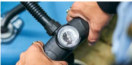
5 Gonflez jusqu'à la pression requise qui doit se situer entre **15 ET 20 PSI**. Il est normal d'entendre un petit sifflement d'air au niveau du tuyau de pompe pendant le gonflage. En effet, l'étanchéité du tuyau n'est jamais parfaite, mais les pertes sont insignifiantes. De même, **l'aiguille du manomètre ne commencera à bouger que lorsque la pression interne de la**
