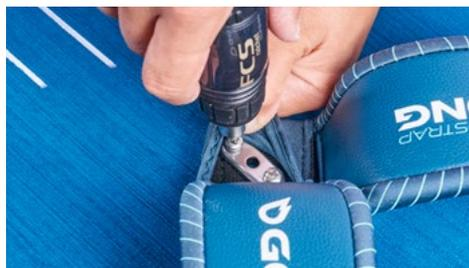
3 **ATTENTION :** il est impératif de visser parfaitement à la verticale du filetage et de ne surtout pas laisser de sable dans le filetage avant de visser. Vous pourriez causer des dommages non réparables dans le filetage.
